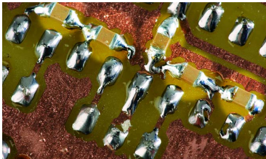
Figuur 4. Hier zijn de SMD-componenten goed te zien.
